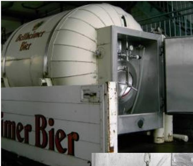
Kreuznach feststellen konnte. Hiermit soll sichergestellt werden, dass der Tank sich in einer definierten (waagerechten) Position befindet, wenn geprüft wird, ob die Inhaltsangaben (Volumen) korrekt sind.
