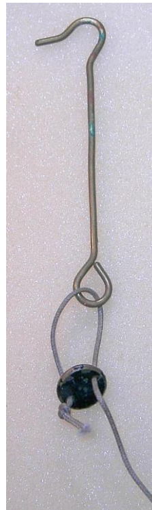
Messingschieber mit Haken für Dreibein
