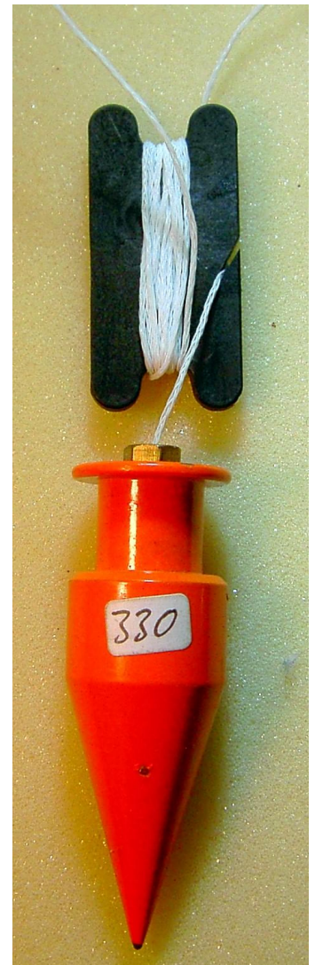
Billiges Plastikteil als Einsteller mit Vermesslerlot.
