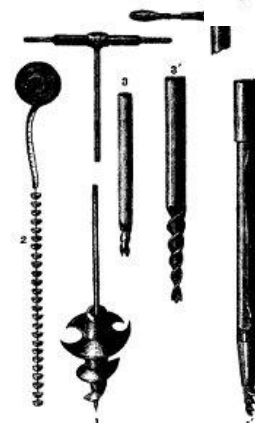
Fig. 31. 1 Tellerbohrer, 1 Röhrenbohrer, 2 Pettenkofer's Meßband zur Bestimmung des Grundwasserspiegels, 3, 3' Eisenrohr mit Schraubspitze zum Einführen von Aspirationschören in den Boden.
